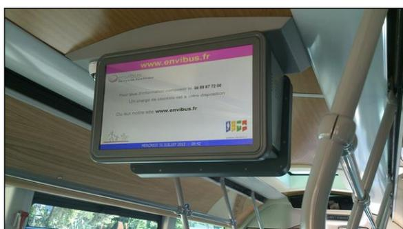
Le **nouvel écran vidéo embarqué** simple face ou double face (dièdre) est un produit dont la conception électronique et mécanique a été entièrement réalisée par CECCLI. Le principe modulaire de cet ensemble permet de réaliser un montage de ce produit en simple ou double face (Bus, Trolleys ou Tramway), soit une intégration directement dans la structure d'un Bus (voussoir) ou dans une rame de tramway.
