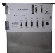
Le **coffret TETRA** est homologué à la norme ferroviaire EN 50155. Il assure l'acheminement des données reçues vers le calculateur SAE embarqué via une liaison RS485 dans les tramways. Une liaison Ethernet est également disponible.
